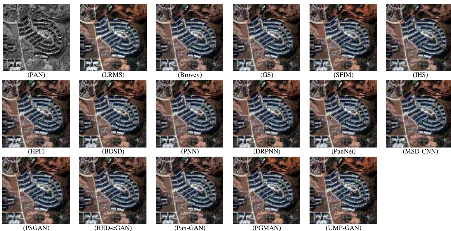
شکل (۷): نتایج بصری روش های مختلف ادغام تصاویر در مجموعه داده های با وضوح کامل متعلق به سنجنده QB Fig. (7): Qualitative comparison of different methods for pansharpening under the full-resolution test on the data from QB
