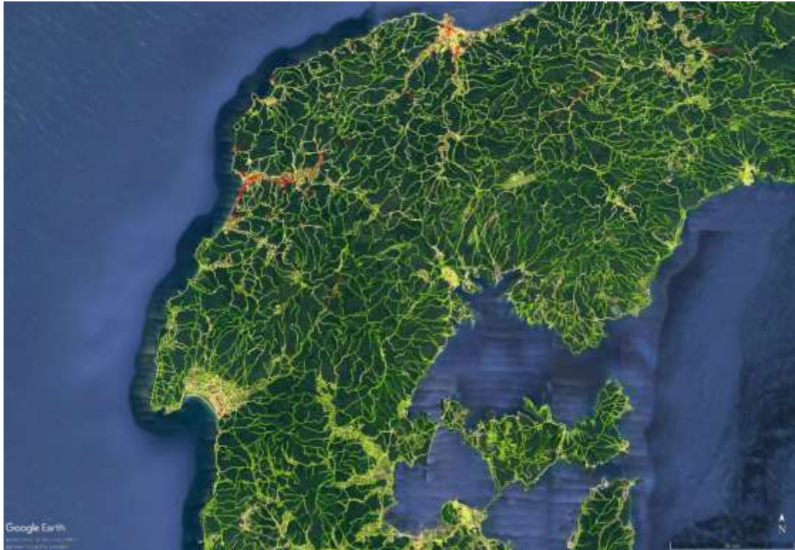
شکل (۷): آسیب پذیری جاده ها و خیابان های درجه ۱ و ۲ بر اساس اختلاف همدوسی.
